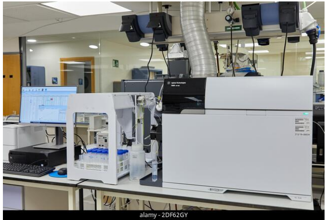
Hình 2. 4. Thiết bị phá mẫu vi sóng MARS và phân tích kim loại Agilent Technologies 7900 ICP-MS
