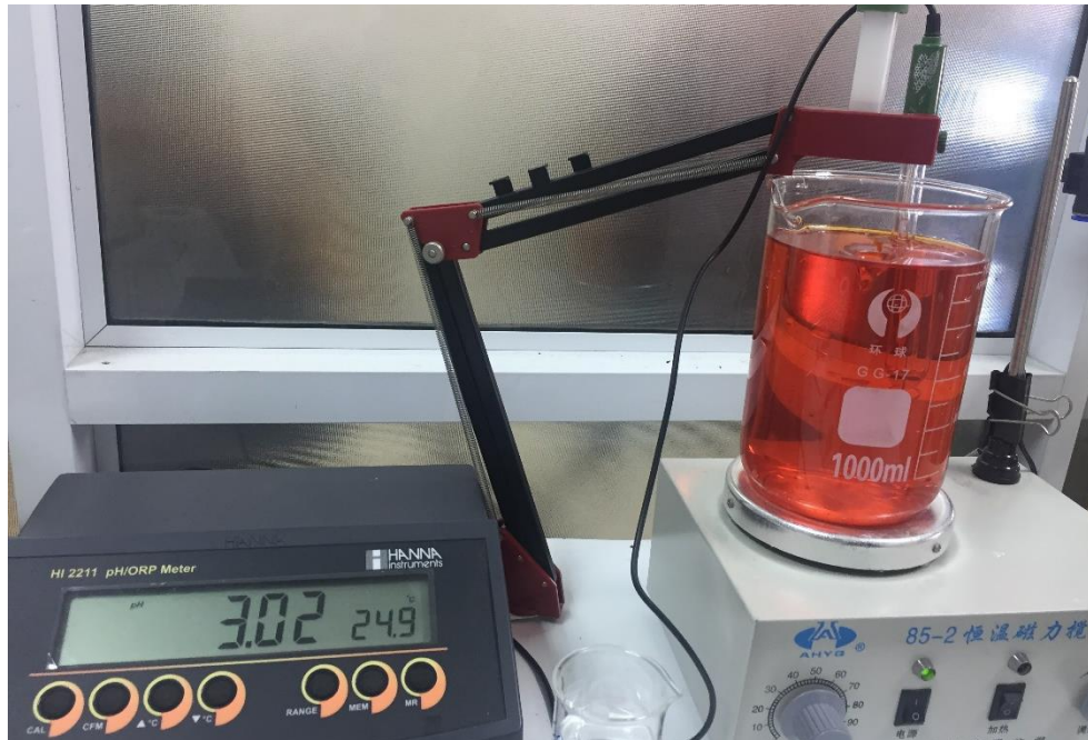
Hệ thí nghiệm Fenton
