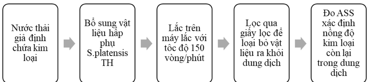
Hình 2.2. Sơ đồ thực nghiệm khảo sát hấp phụ ở chế độ tĩnh
