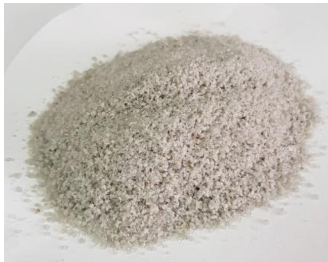
Hình 2. 2. Vật liệu A-BFS3 thu được từ xi lò cao
