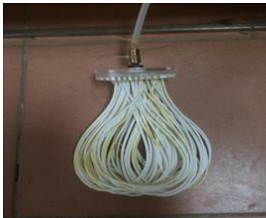
Hình 2.7. Hình ảnh modun màng MBR sử dụng trong các thí nghiệm của đề tài
