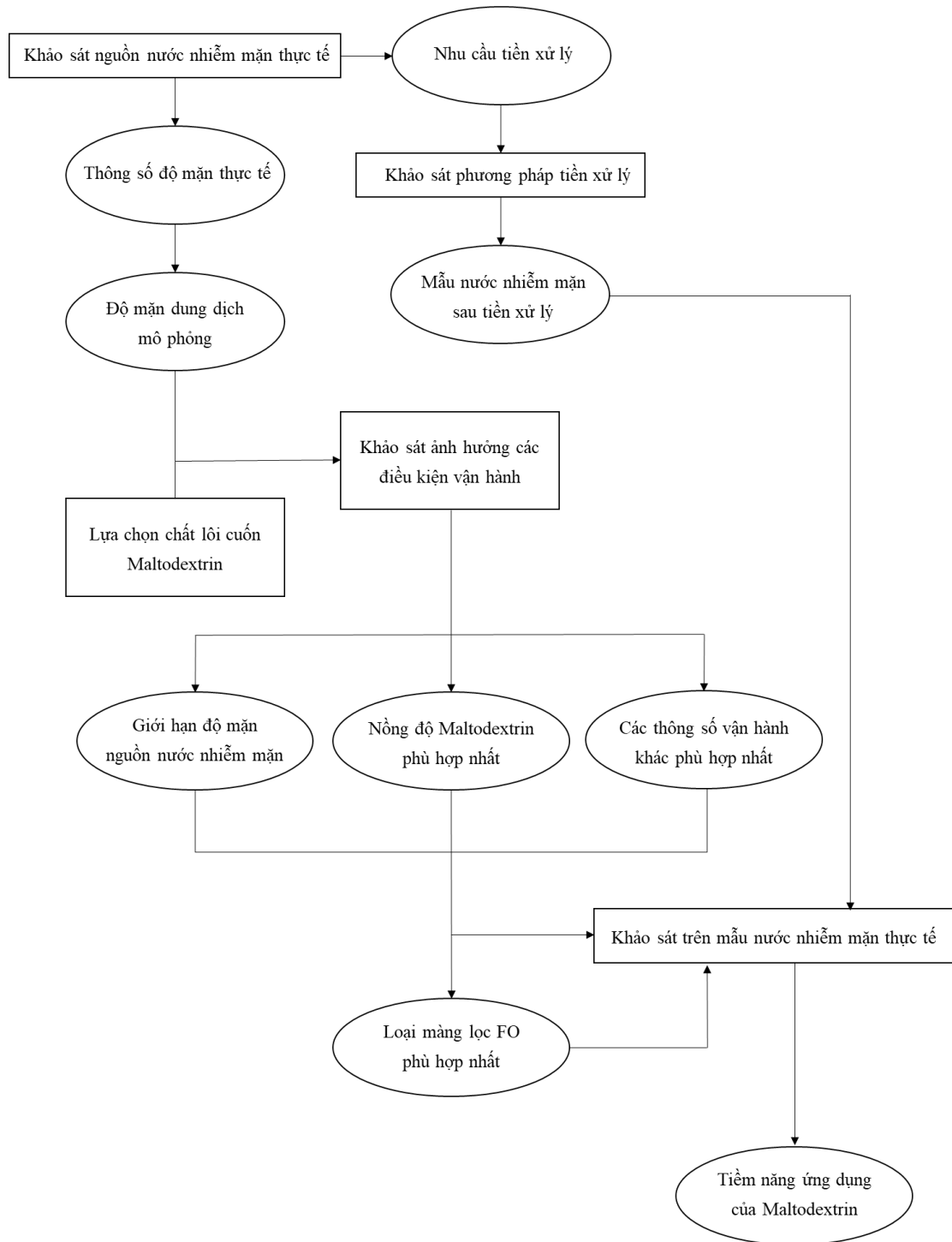
Hình 2.2 Sơ đồ khối các phương pháp thực nghiệm lựa chọn chất lõi cuốn, màng lọc thẩm thấu xuôi, và các điều kiện vận hành
