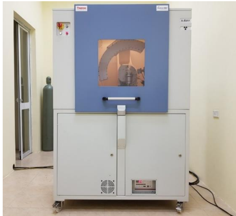
Hình 2.5. Thiết bị nhiễu xạ tia X Equinox 5000.
