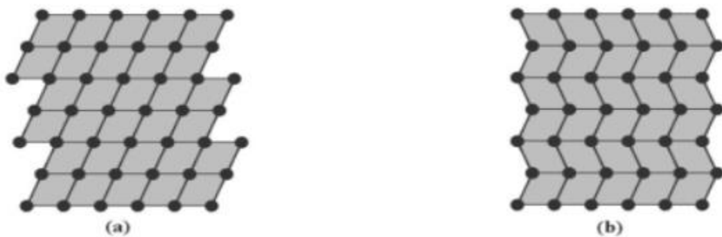
Hình 1.4. Hai cơ chế trượt (a) và kết cặp (b).
