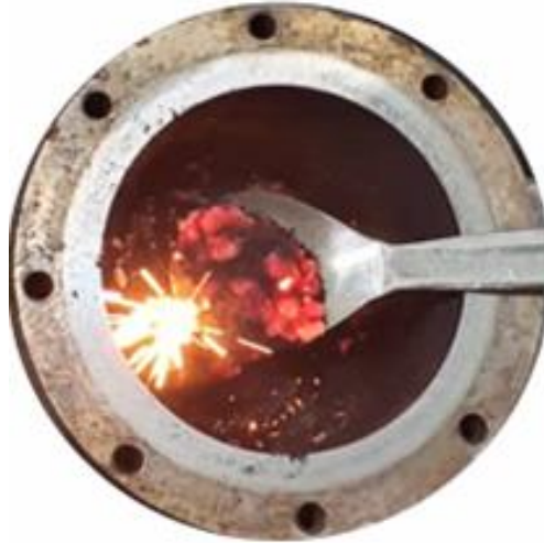
Hình 3.3. Hỗn hợp bột được nghiền > 60 phút sẽ dễ gây ra phản ứng cháy khi thao tác.
