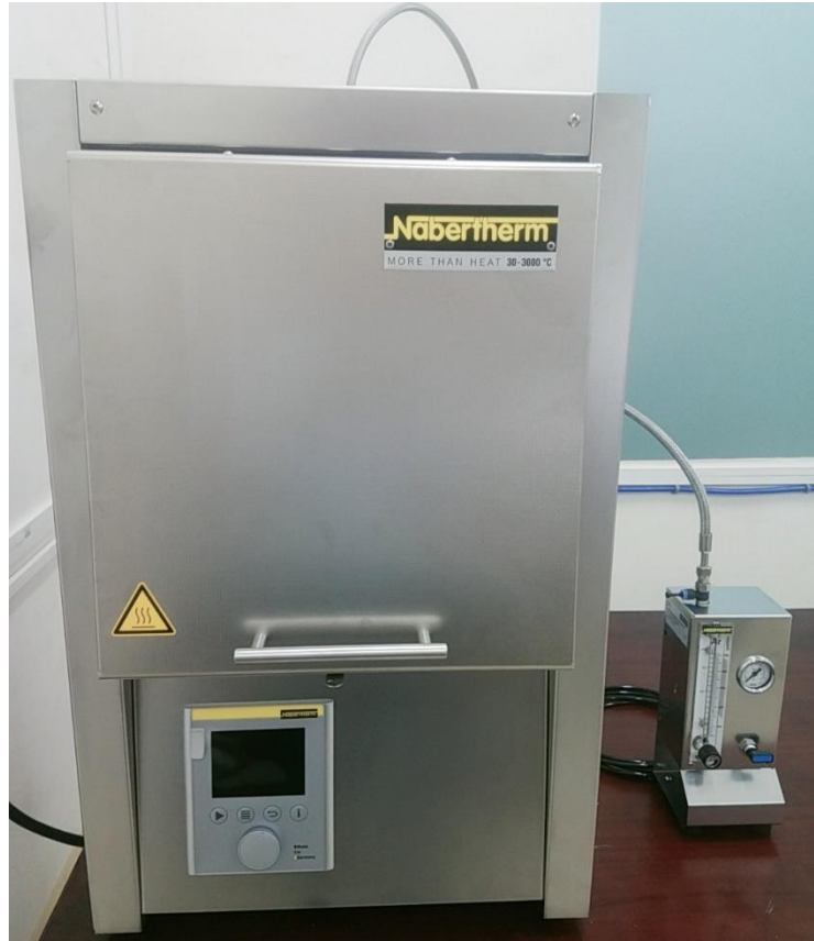
Hình 2.1. Lò nung nhiệt độ 1800°C tại phòng thí nghiệm Khoa học vật liệu của Khoa Vật lí, trường ĐH Sư Phạm-ĐH Đà Nẵng.
