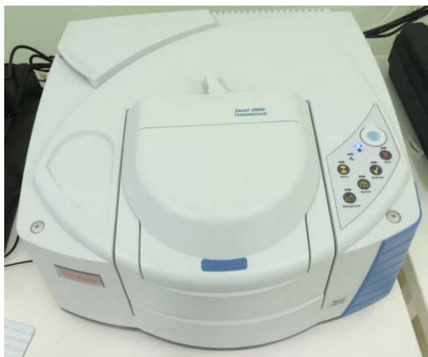
Hình 2.4. Thiết bị ghi phổ hồng ngoại Nicolet iS10 (Thermo Scientific, Mỹ).
