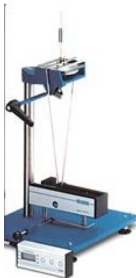
Hình 2.12. Thiết bị đo độ cứng tương đối Erichsen model 506 (Đức).
