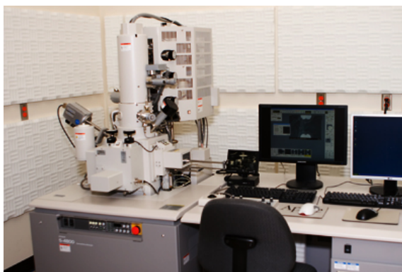
Hình 2.5. Thiết bị hiển vi điện tử quét trường phát xạ S-4800 (Hitachi, Nhật Bản).
