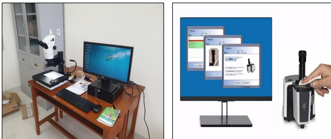
Hình 2.3. Thiết bị kính hiển vi và quang phổ hồng ngoại ATR-FTIR
