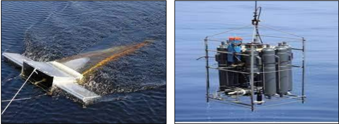
Hình 1.6. Thiết bị thu mẫu vi nhựa trong môi trường nước
