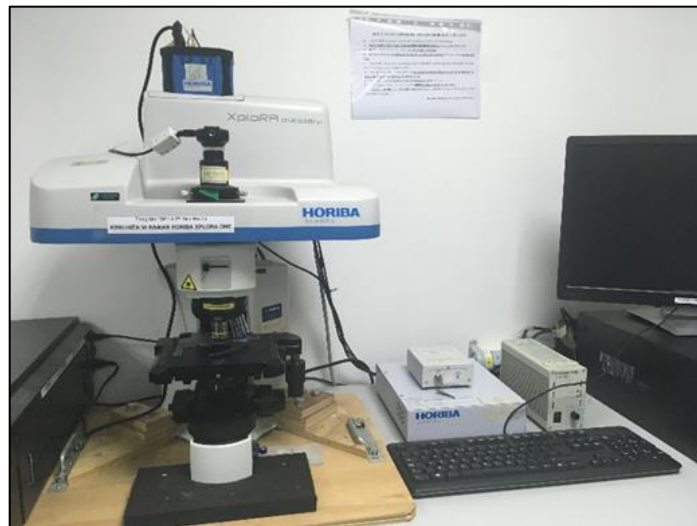
Hình 1.12. Raman Hệ đo kính hiển vi Raman Xplora One
