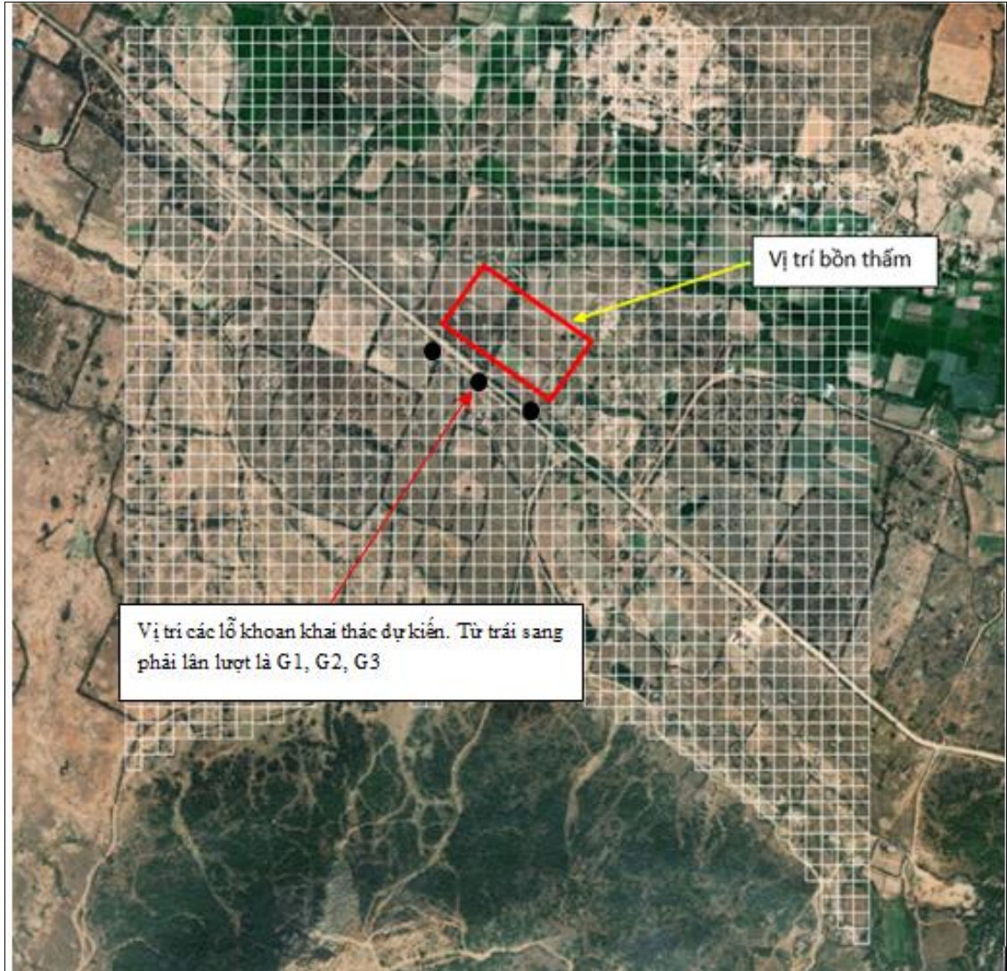
Hình 4.56. Vị trí các giếng khoan dự kiến trên mô hình
