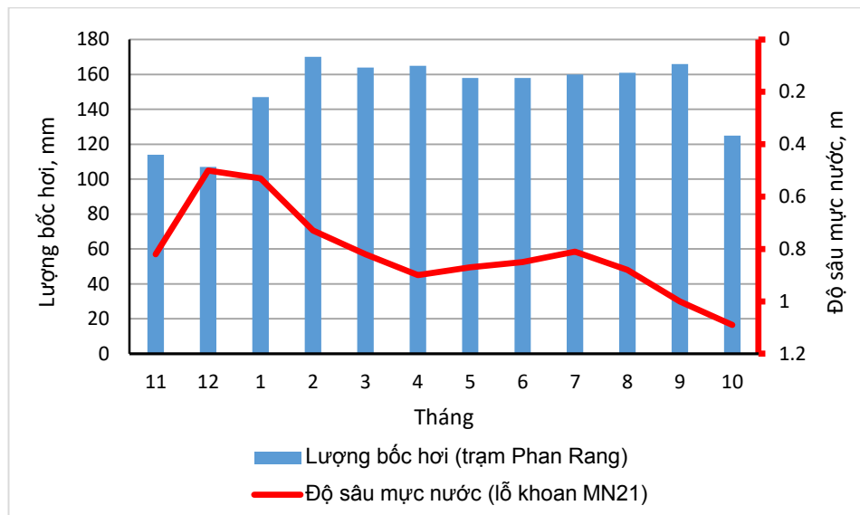
Hình 3.3. Biểu đồ tương quan lượng bốc hơi và mực nước giếng khoan MN21
