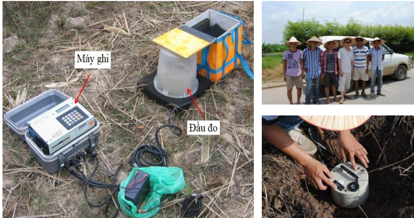
Hình 3.1. Thiết bị đo dao động vi địa chấn sử dụng và môi trường khảo sát
