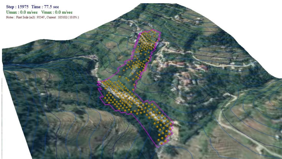
Hình 5. 15. Kết quả phân tích phạm vi vận động của KTL Tân Sơn bằng phần mềm LS Rapid
