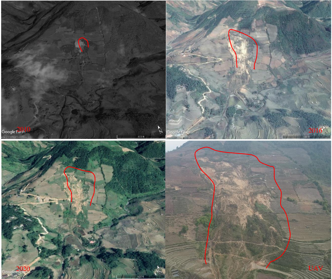
Hình 3. 18. Hình ảnh Google Earth và ảnh chụp UAV khảo sát thể hiện diễn biến mở rộng KTL Chê Cu Nha, Mù Cang Chải trước các năm 2010, 2016 và 2020 b./ Các kiểu dịch chuyển KTL
