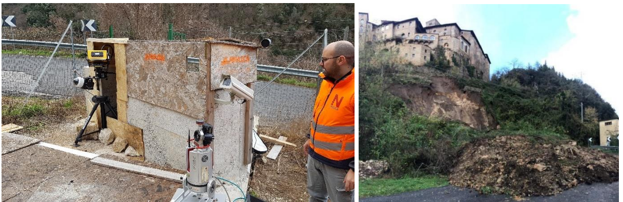
Hình 1. 7. Hệ thống quan trắc bằng công nghệ T-InSar theo dõi KTL dưới chân tu viện thánh Scholastica tại Subiaco, Italia
