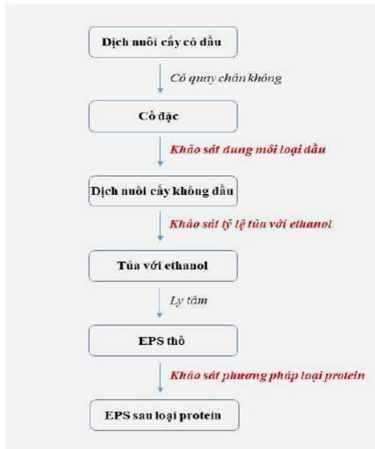
Hình 2.2. Sơ đồ tách chiết EPS từ dịch nuôi cấy C. sinensis bổ sung dầu
