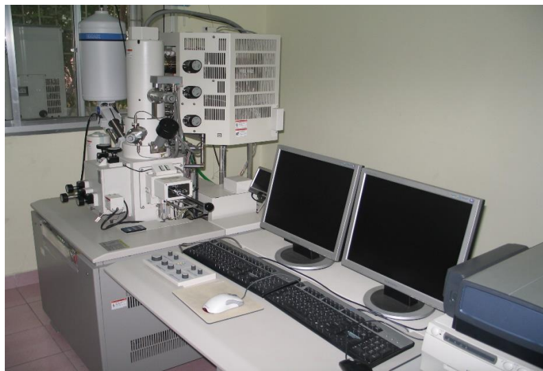
Hình 2.11. Kính hiển vi điện tử quét HITACHI S-4800.
