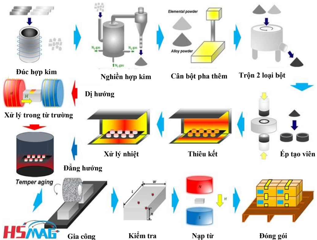
Hình 1.9. Các công đoạn trong quy trình chế tạo nam châm Alnico bằng phương pháp bột thiêu kết.
