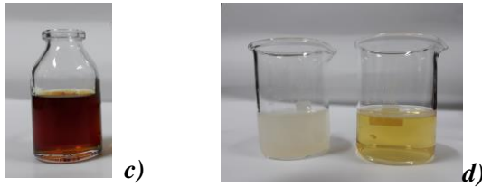
Hình 1: Cây Larix Sibirica (1a), flavonoid dạng bột (1b), flavonoid dạng nano (1c) và khả năng phân tán trong nước của mẫu flavonoid dạng bột và dạng gel nano (1d)
