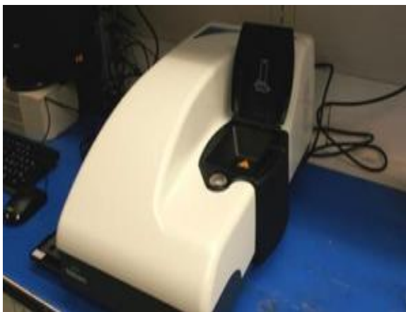
Hình 2.4: Máy đo Zetasizer S90 của hãng Malvern Instruments (trái) và nguyên tắc hoạt động của nó (phải)
