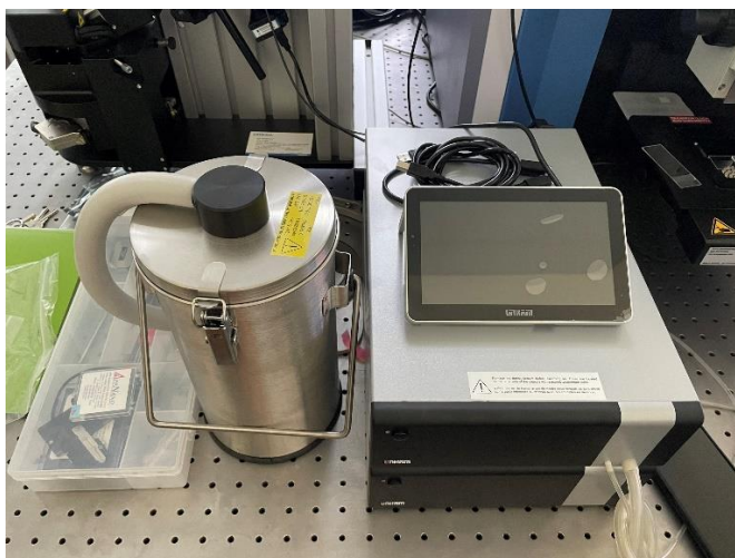
Hình 2.4: Hệ Linkam THMS600 cho phép thay đổi nhiệt độ từ 80 K tới 900 K
