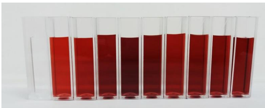
Hình 2.3 Dung dịch AuNPs/CD ở các điều kiện nồng độ CD khác nhau (từ 0 mM đến 20 mM).
