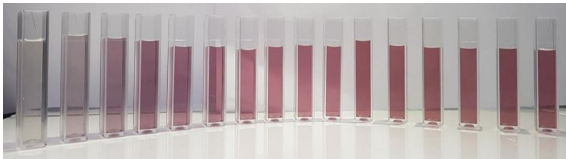
Hình 2.5. Dung dịch AuNPs/CD sau các khoảng thời gian phản ứng (từ 0 phút đến 50 phút).
