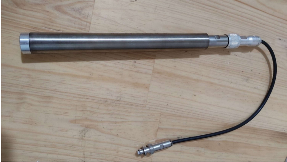
Hình 2.9. Ống đếm ^3\text{He} LND 2528 sử dụng trong thí nghiệm
