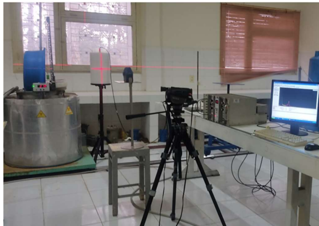
Hình 2.19. Sử dụng thước laser định vị hỗ trợ điều chỉnh vị trí hệ Bonner
