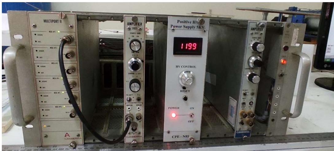
Hình 2.14. Các khối điện tử hệ phổ kế đa kênh Multiport II (Canberra)
