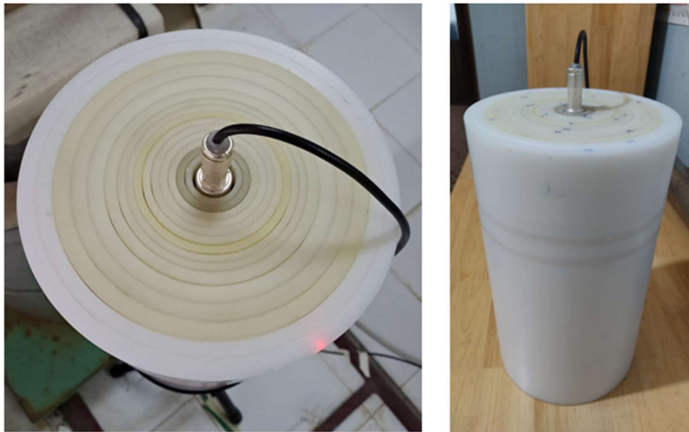
Hình 2.5. Hệ BCS gồm 15 lớp PE lồng vào nhau với ống đếm ^3\text{He} lắp đặt ở trung tâm
