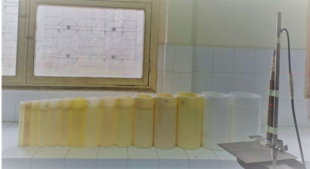
Hình 2.4. 15 ống trụ PE đã được chế tạo với kích thước theo thiết kế
