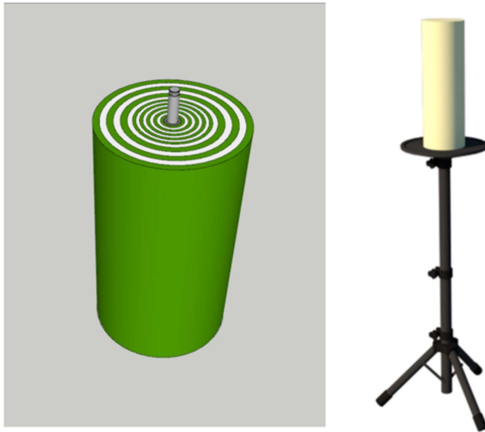
Hình 3.1. Kết quả thiết kế mô hình các ống trụ PE và giá đỡ của hệ phổ kế Bonner-Cylinder
