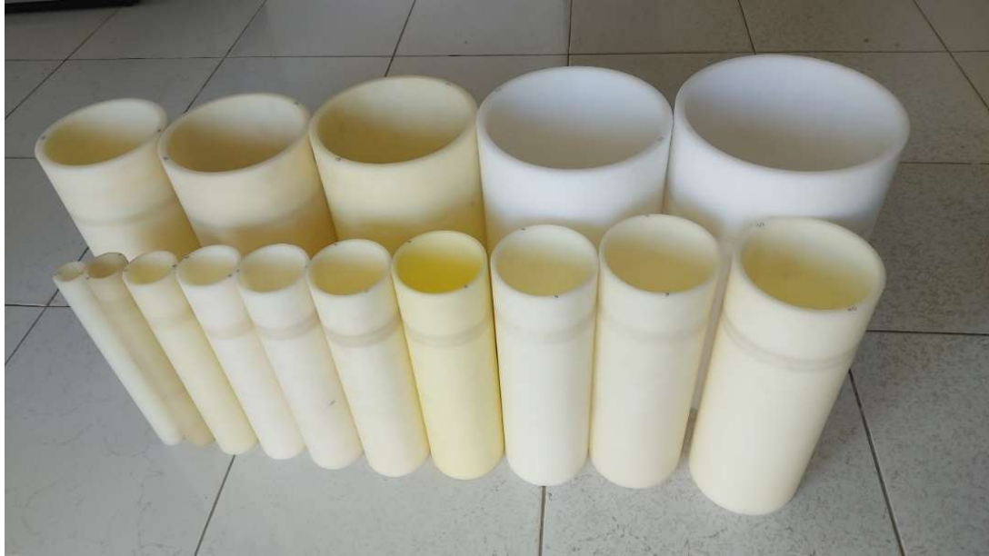
Hình 3.2. 15 ống trụ làm chậm neutron bằng PE của hệ Bonner-Cylinder đã được chế tạo
