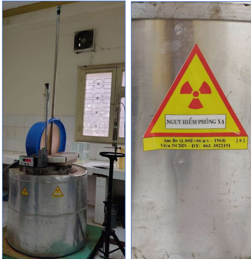
Hình 2.11. Howitzer chứa nguồn ^{241}\text{Am} -Be
