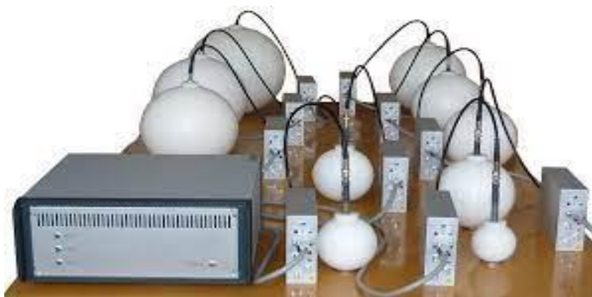
Hình 1.10: Mô hình hệ phổ kế hình cầu BSS[8]
