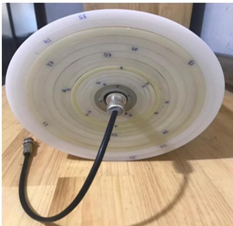
Hình 2.3: Hệ gồm 15 khối trụ PE được lắp ghép với đầu dò ^3\text{He}
