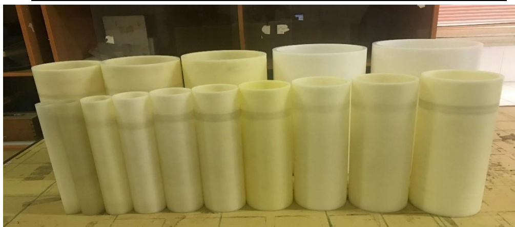
Hình 2.2: Các lớp làm chậm neutron bằng vật liệu PE
