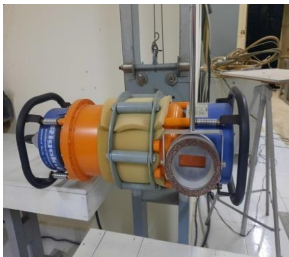
a. Ống phát tia X “RF-200EGM2” b. Bàn điều khiển máy phát tia X
