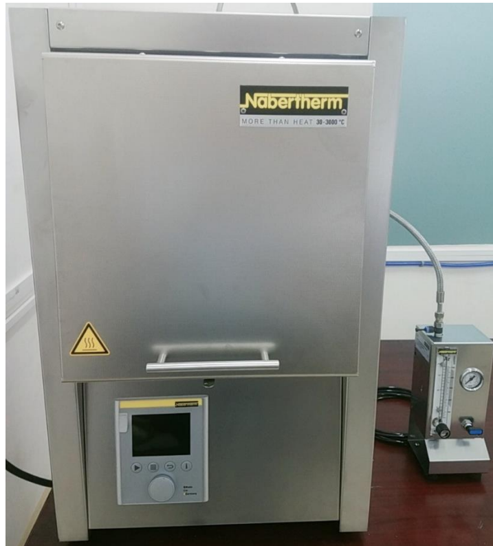
Hình 2.4. Lò nung nhiệt độ 1800 °C tại phòng thí nghiệm Khoa học vật liệu của Khoa Vật lí, Trường ĐH Sư Phạm - ĐH Đà Nẵng.
