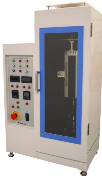
Hình 2.3: Thiết bị phân tích độ bền cháy mẫu treo phương dọc Yasuda – No.440
