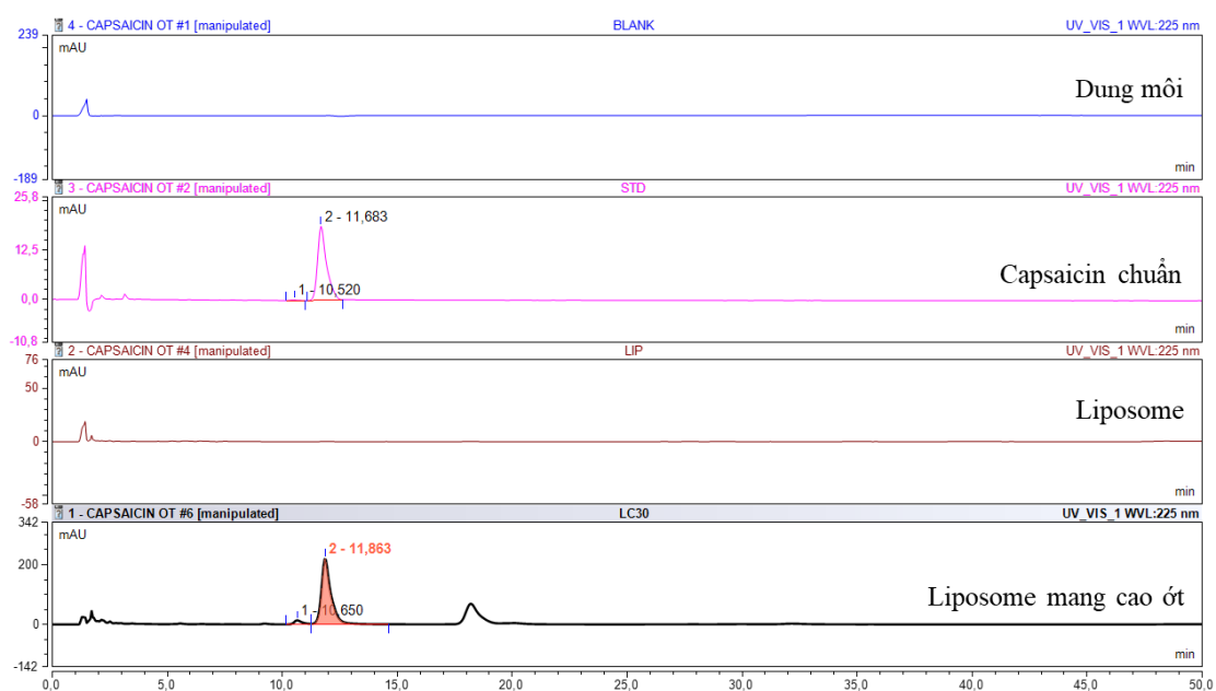
Hình 3.5 Tính đặc hiệu của phương pháp định lượng capsaicin trong liposome mang cao ớt
