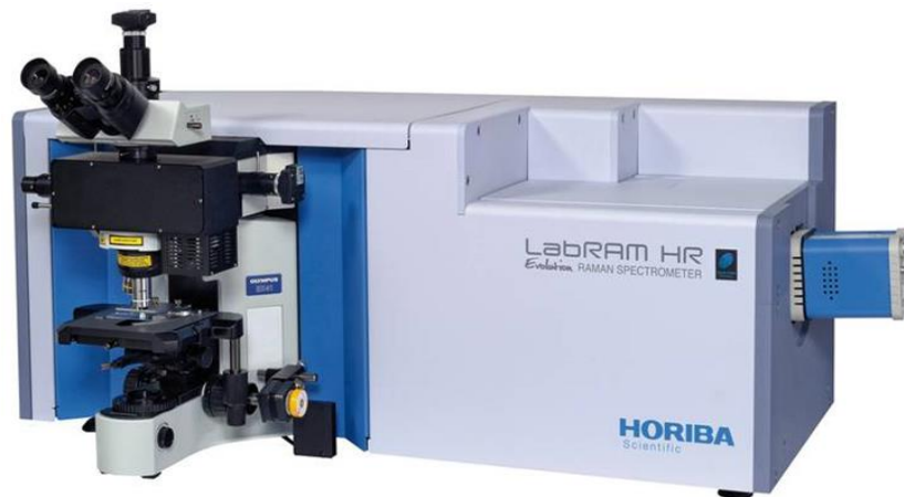
Hình 4.8. Thiết bị phân tích quang phổ Micro-Raman LabRAM HR Evolution.
