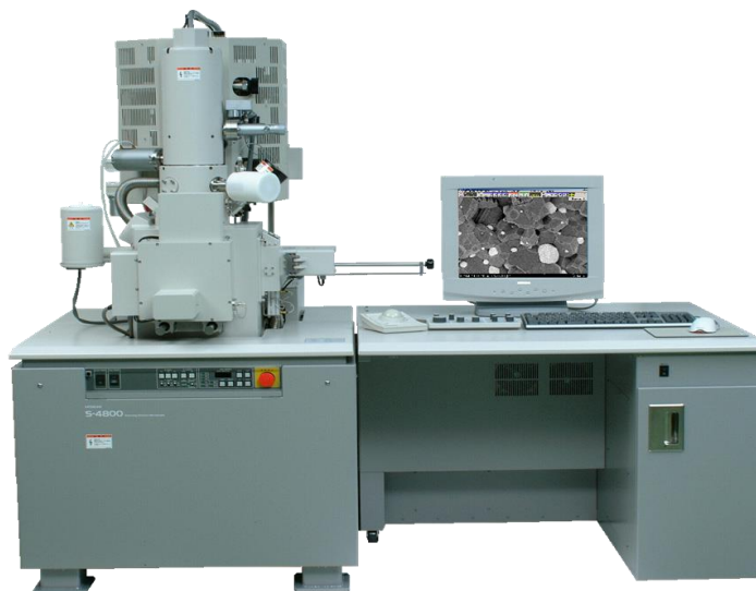
Hình 4.3. Thiết bị hiển vi điện tử quét phân giải cao FE-SEM (S-4800 Hitachi).
