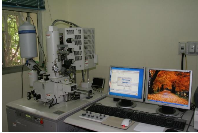
Hình 2.10. Toàn cảnh hệ kính hiển vi điện tử quét SEM tại Viện Khoa học vật liệu
