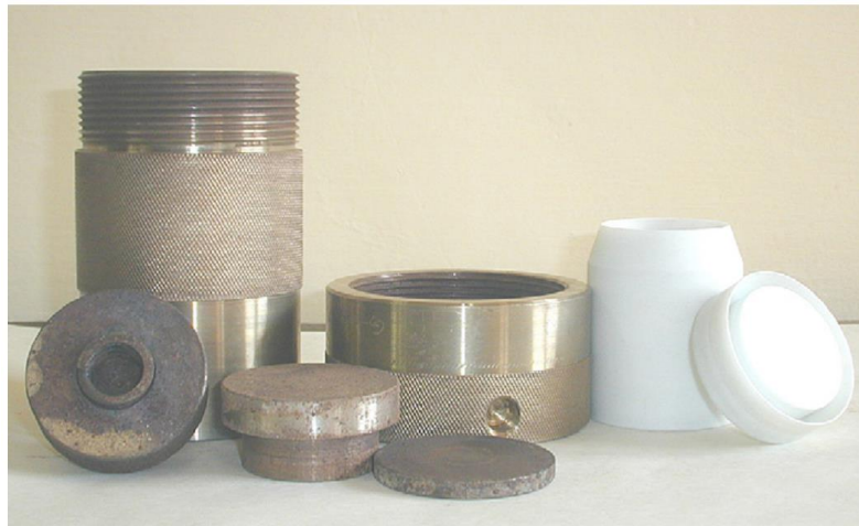
Hình 1.21. Thiết bị dùng trong tổng hợp vật liệu bằng phương pháp thủy nhiệt [93]
