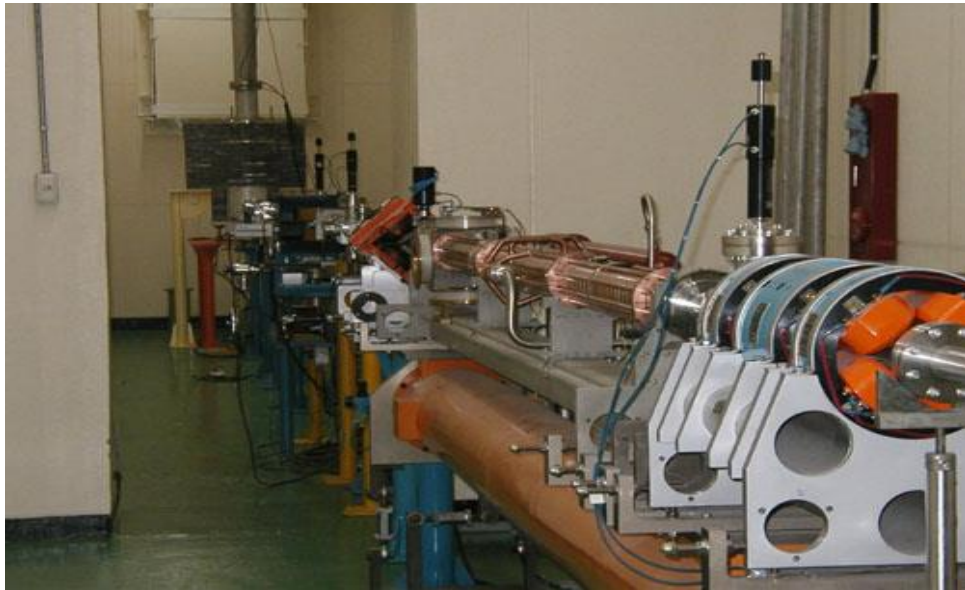
Hình 2.3. Hình ảnh máy gia tốc electron tuyến tính 100 MeV tại PAL, Hàn Quốc.
