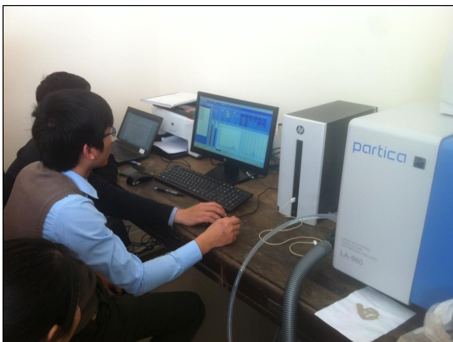
Hình 2.10. Phân tích mẫu trầm tích bằng máy phân tích độ hạt LA960 – Horiba
