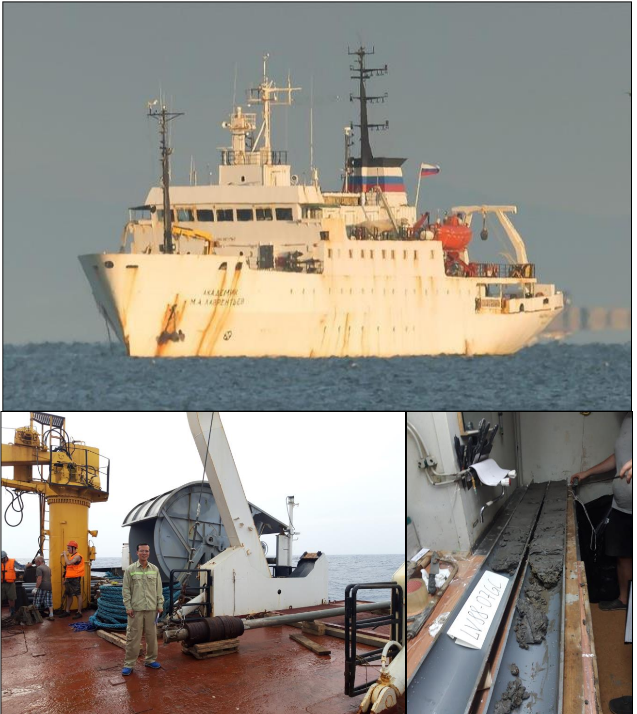
Hình 2.9. Ống phóng trọng lực sau khi được kéo lên và được xử lý trong phòng lấy mẫu trên tàu Lavrentyev
