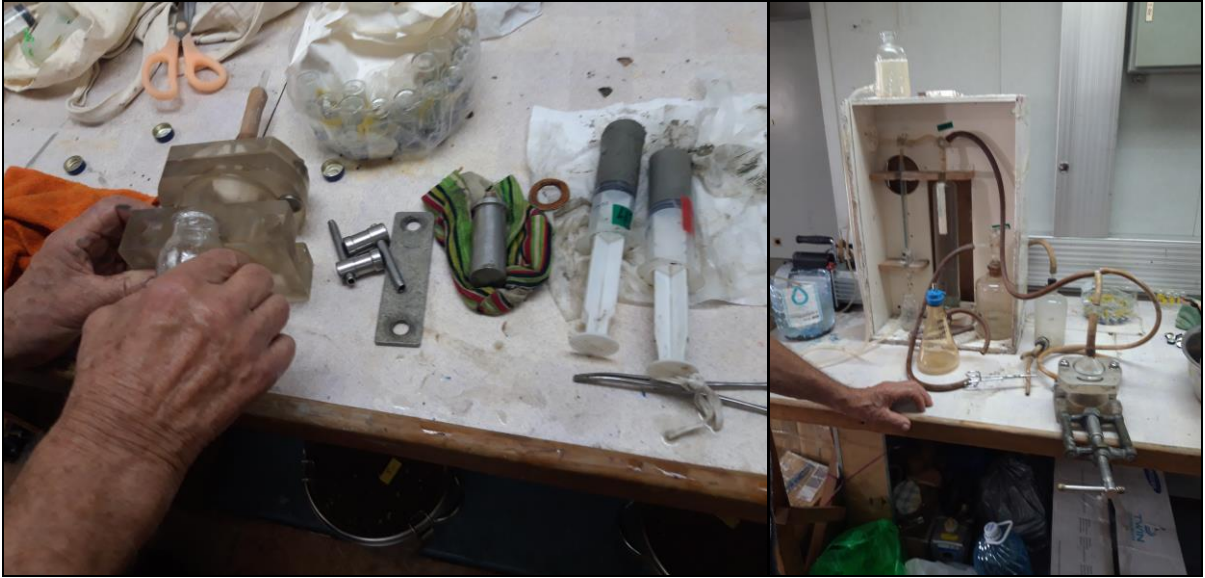
Hình 2.15. Chuẩn bị bộ chứa mẫu và kết nối với bộ tách khí chân không
