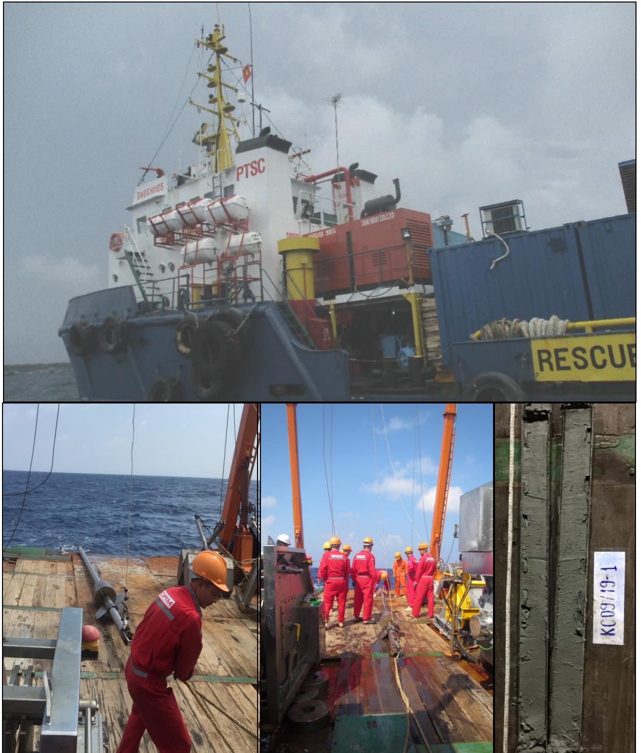
Hình 2.8. Công tác lấy mẫu trầm tích bằng ống phóng trọng lực trên tàu DK105
