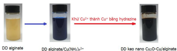
Hình 3.1. Sự thay đổi màu sắc khi khử [\text{Cu}(\text{NH}_3)_4]^{2+}/\text{alginate} bằng \text{N}_2\text{H}_4
