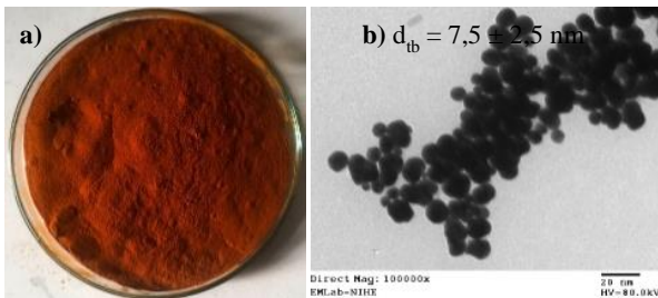
Hình 3.20. Bột nano Cu 2 O-Cu/alginate (a) và ảnh TEM (b)
