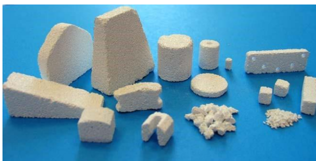
Hình 1.2. BCP có thể được sản xuất dưới dạng bột, viên, khối đặc hoặc xốp [7]
