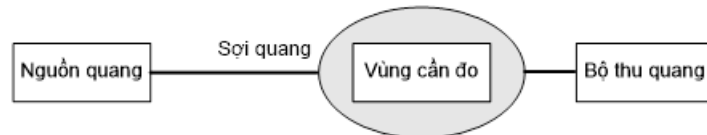
Hình 3.4: Cấu trúc chung của hệ thống cảm biến quang
