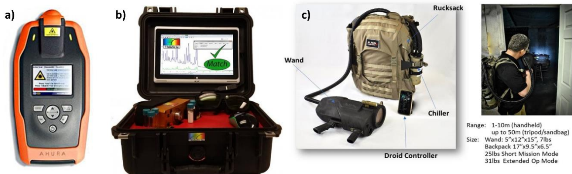
Hình 1.17. Một số dạng máy quang phổ Raman xách/cầm tay [158-160].
