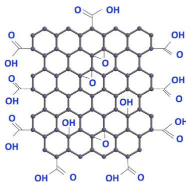
Hình 1.3. Cấu trúc mạng lục giác của các tấm mỏng graphene oxide.
