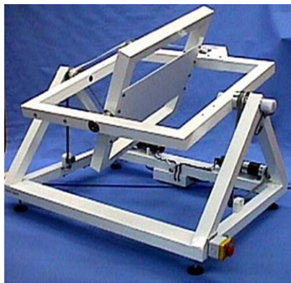
Hình 1.9. Máy định vị ngẫu nhiên với 2 trục vuông góc với nhau [27].
