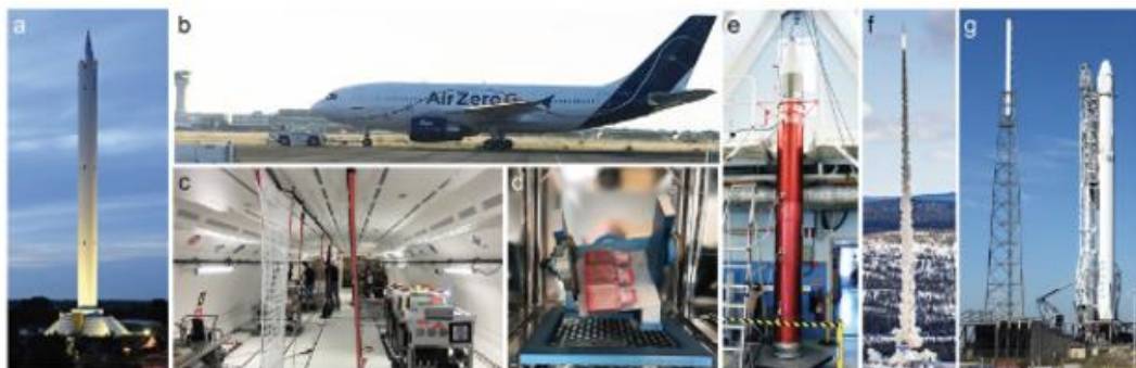
Hình 1.6. Một số thiết bị mô phỏng vi trọng lực được sử dụng nghiên cứu [23]. (a: tháp rơi, b: máy bay vi trọng lực, c: bên trong máy bay vi trọng lực, d: máy định vị ngẫu nhiên, e: tên lửa nghiên cứu, f: bắt đầu phóng tên lửa nghiên cứu, g: tên lửa nghiên cứu trên bệ phóng)
