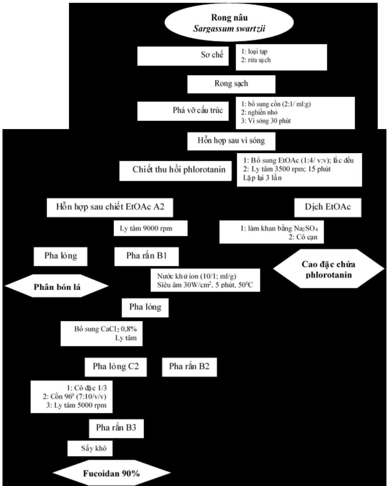
Hình 3.14. Quy trình chiết xuất Fucoidan từ rong nâu
