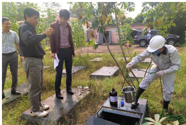
Hình 2.1 Thu thập mẫu nước thải tại bể chứa trước xử lý
