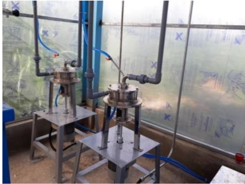
Hình 1.14. Thiết bị hấp thụ li tâm làm sạch khí biogas trong đề tài thuộc Chương trình Tây Nguyên 2016 – 2020.
