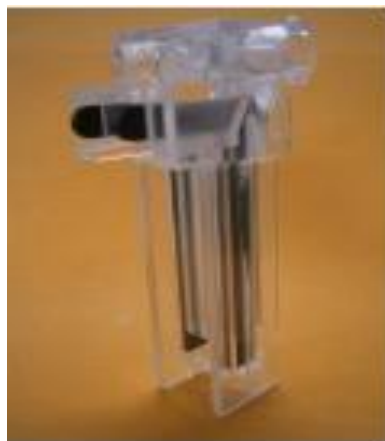
Hình 19. Cuvet nhựa có điện cực than chì để đo thế zeta
