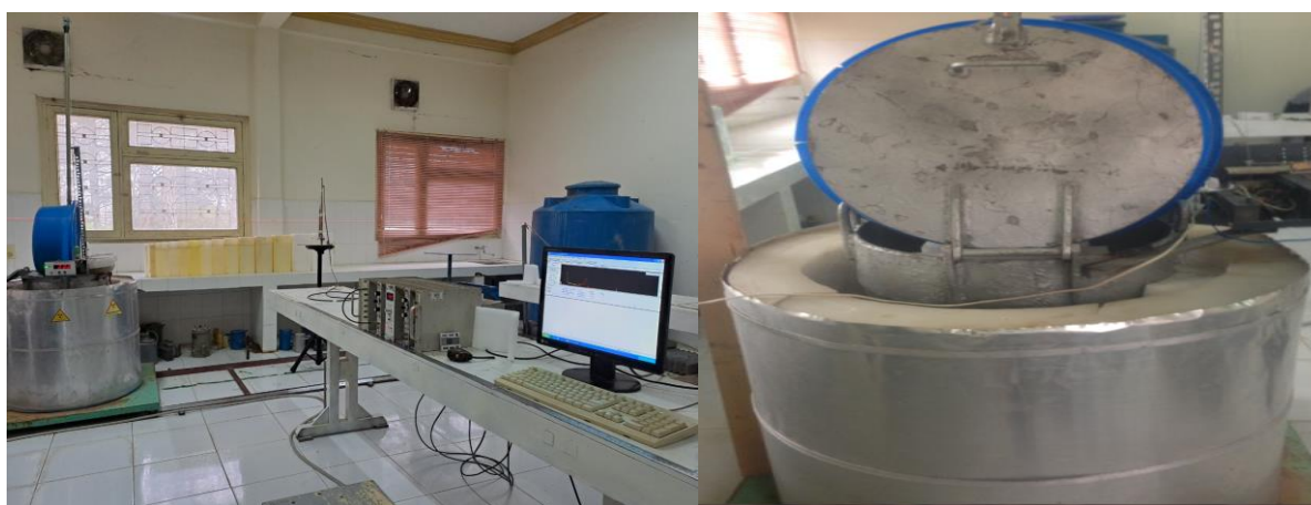
Hình 2.1. Hệ chiếu chuẩn neutron dùng nguồn Am-Be
