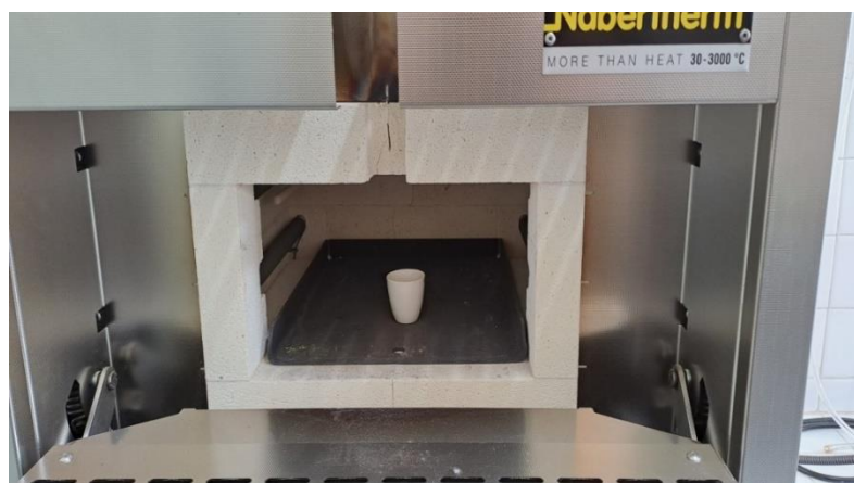
Hình 2.5. Cốc sứ đựng mẫu đặt trong lò nung để ủ nhiệt vật liệu K_2GdF_5:Tb
