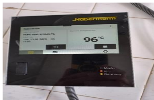
Bản điều khiển nhiệt độ lò nung bằng phần mềm chuyên dụng của hãng sản xuất NaberTherm
