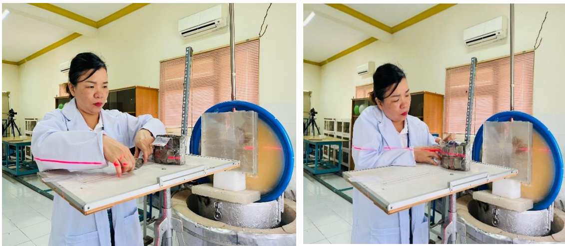
Hình 2.8. Bố trí thí nghiệm chiếu xạ mẫu với nguồn neutron Am-Be
