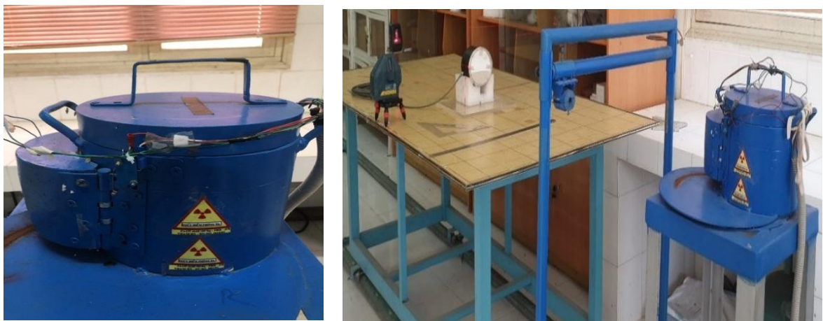
Hình 2.2. Hệ chiếu chuẩn gamma dùng Cs-137
