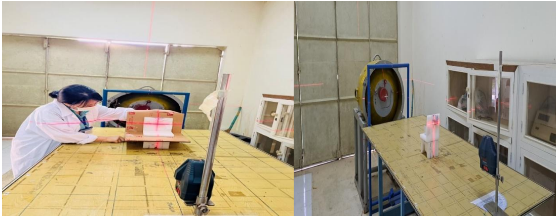
Hình 2.12. Bố trí thí nghiệm chiếu mẫu với bức xạ gamma (Co-60)
