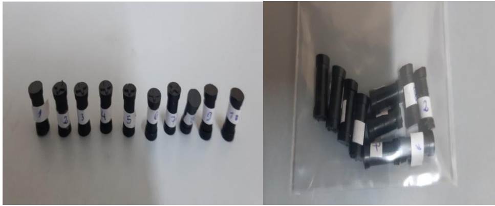
Hình 2.9. Mẫu vật liệu được chuẩn bị cho chiếu xạ.
