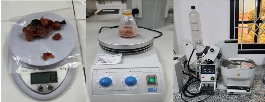
Hình 3. 17. Hình ảnh về thiết bị thí nghiệm (a) cân mẫu cá, (b) máy khuấy từ, (c) hệ thống cô quay.
