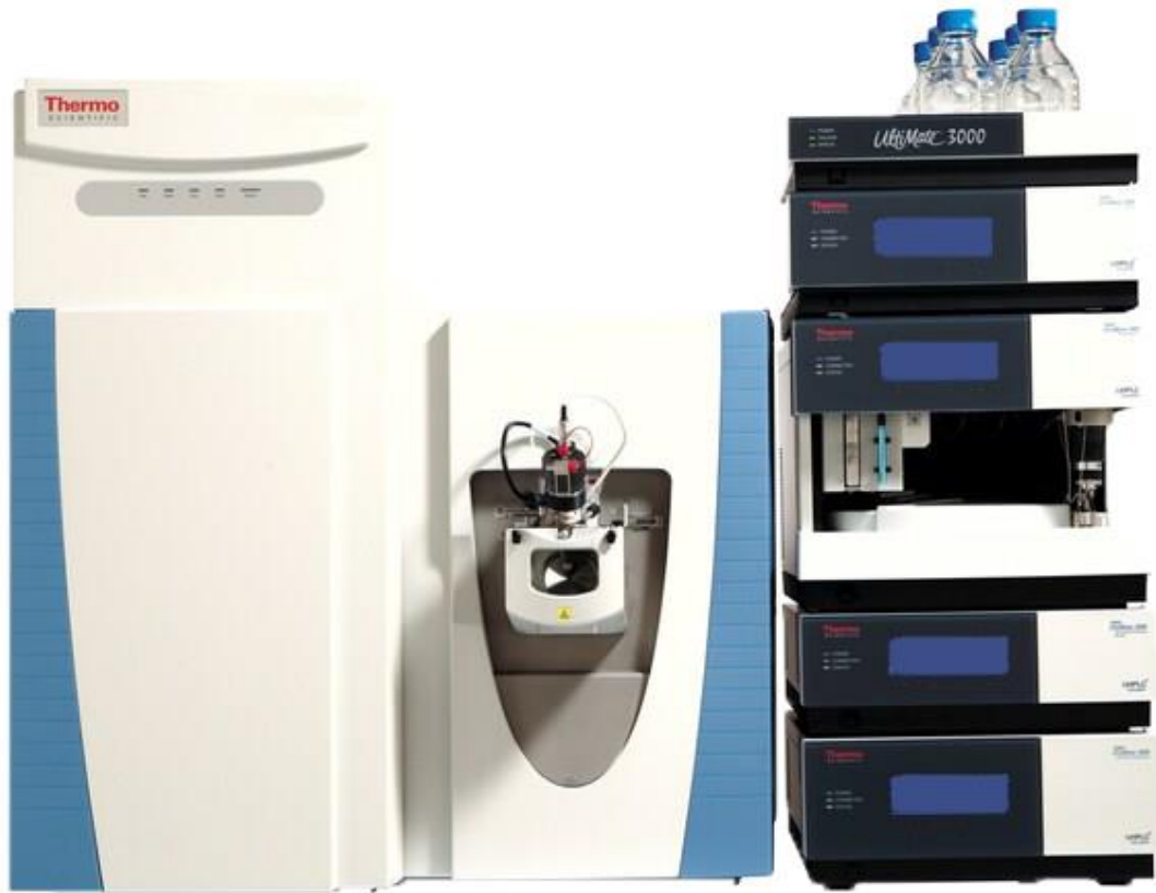
Hình 1.3: Giao diện hệ thống sắc ký lỏng hiệu năng Thermo Liquid Ultimate 3000 RS UHPLC (Dionex) ghép nối đầu dò khối phổ Q Exactive™ Focus Hybrid Quadrupole-Orbitrap™ (Thermo Scientific).
