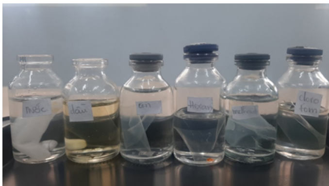
Hình 3.17 Thử nghiệm khảo sát độ bền của màng P_1ZnAc 0,05% trong các loại dung môi
