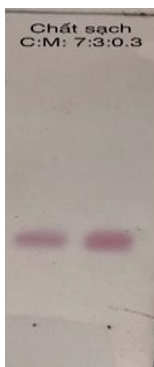
Hình 4. 7: TLC hợp chất HH-01 với hệ dung môi C:Me:W (70:30:3)
