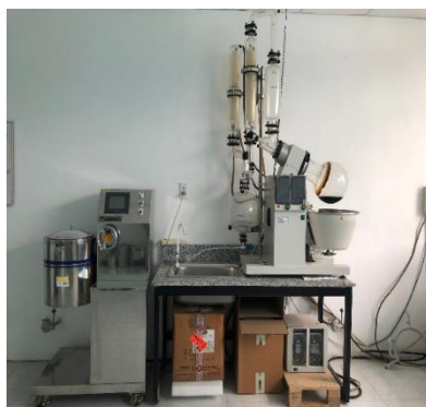
Hình 3. 3: Thiết bị chiết siêu âm và máy cô quay
