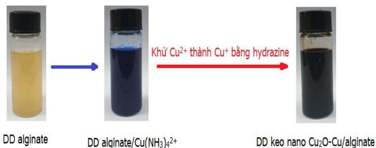
Hình 3.1. Màu sắc của dung dịch alginate, dung dịch phức alginate/ \text{Cu}(\text{NH}_3)_4^{2+} và dung dịch nano \text{Cu}_2\text{O} -Cu/alginate
