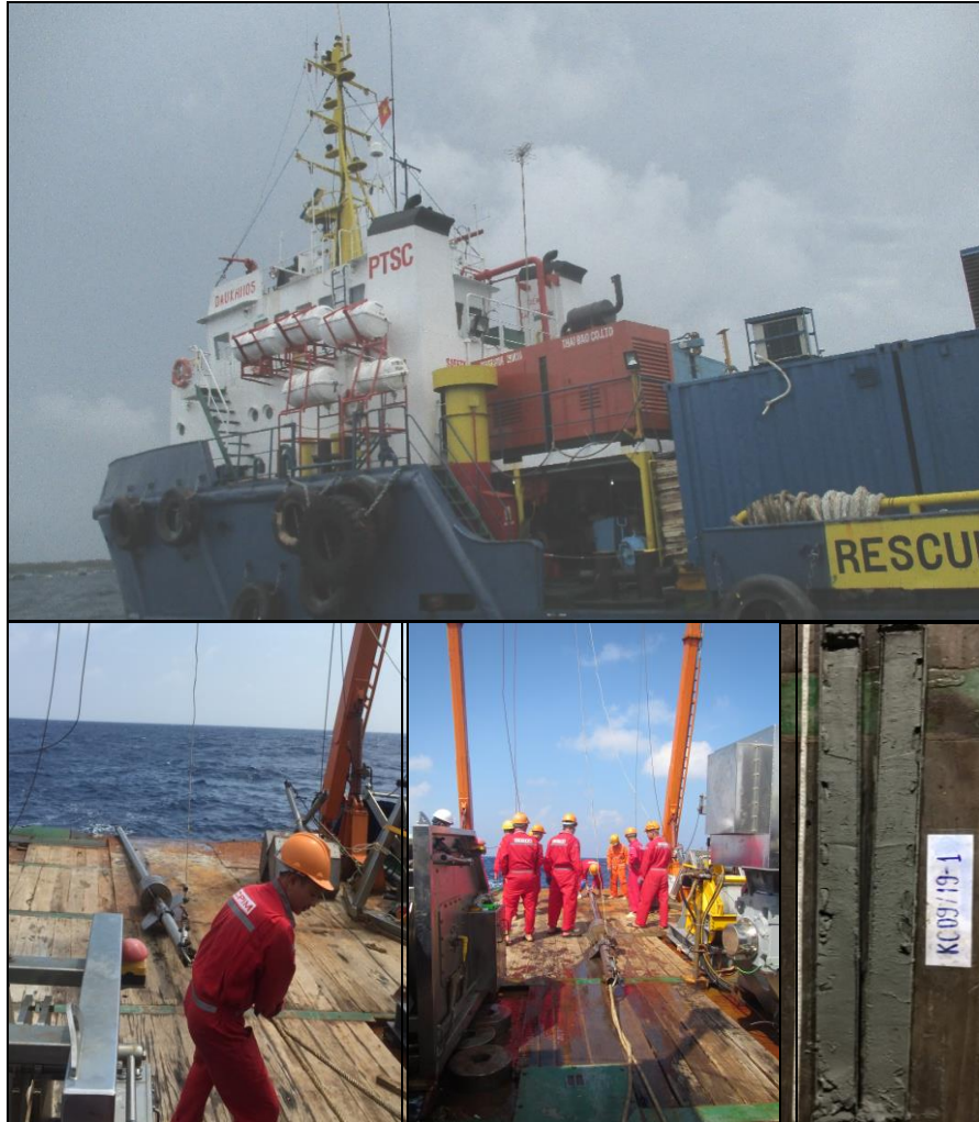
Hình 2.7. Công tác lấy mẫu trầm tích bằng ống phóng trọng lực trên tàu DK105
