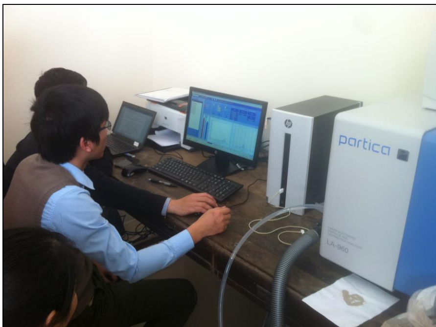
Hình 2.9. Phân tích mẫu trầm tích tầng mặt bằng máy phân tích độ hạt LA960 – Horiba
