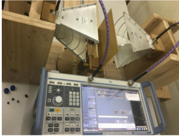
Hình 2.12. Mô hình thiết lập đo hệ số truyền qua
