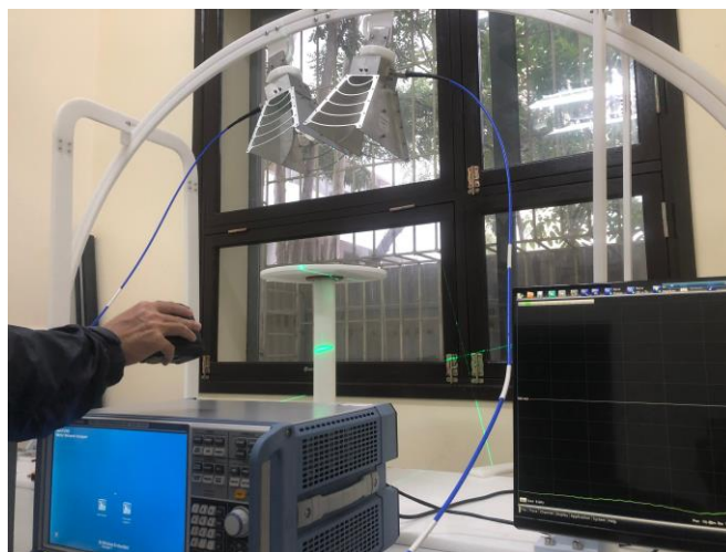
Hình 2.11. Mô hình thiết lập đo hệ số phản xạ
