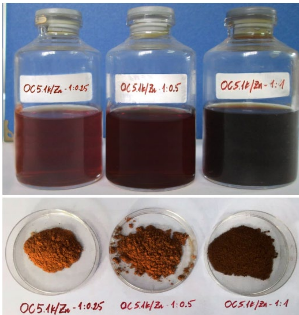
Hình 3.15: Hình ảnh dung dịch và bột của phức oligochitosan-Zn 2+ theo tỷ lệ phần mol khác nhau, tại cùng KLPT OC 5,1 kDa
