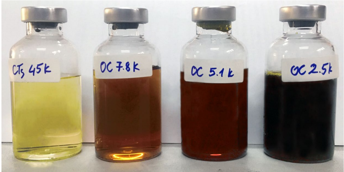
Hình 3.6: Màu sắc của các dung dịch chitosan cắt mạch có KLPT khác nhau Từ trái qua phải lần lượt là: Chitosan 45 kDa, OC 7,8 kDa; OC 5,1 kDa; và OC 2,5 kDa.
