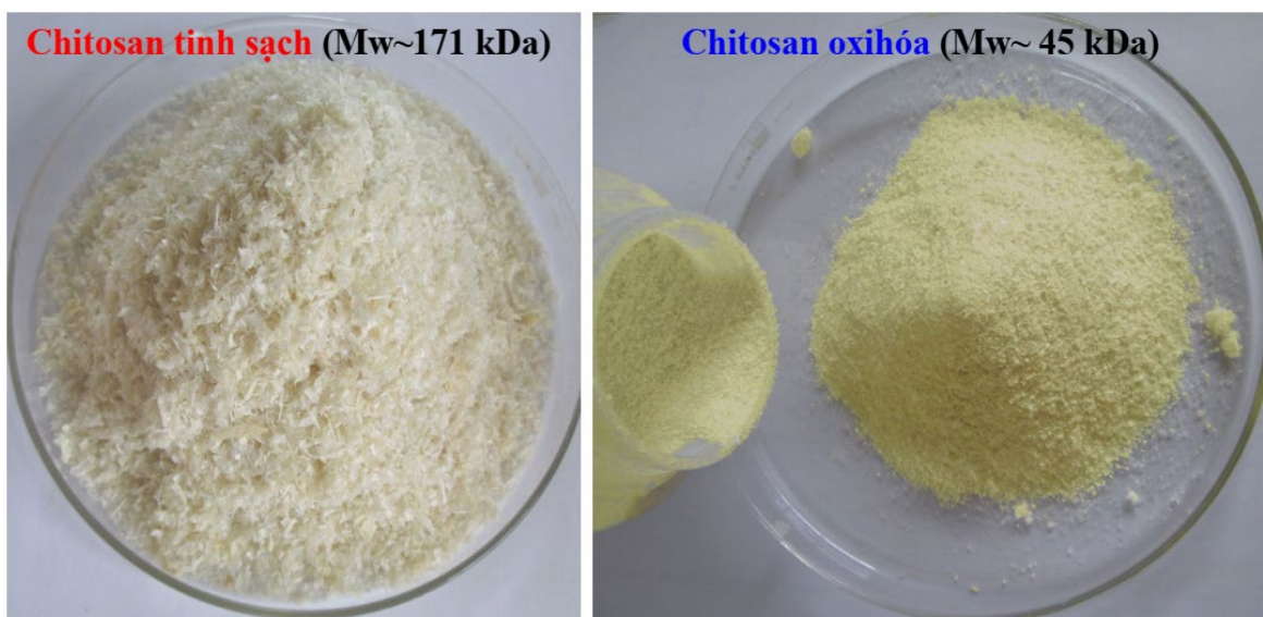
Hình 3.1: Hình dạng vảy chitosan ban đầu ( bên trái ) và chitosan oxi hóa ( bên phải )
