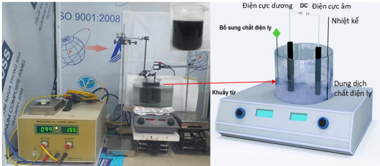
Hình 2.1. Hệ điện hóa chế tạo graphene và hình ảnh sơ đồ bố trí thí nghiệm.
