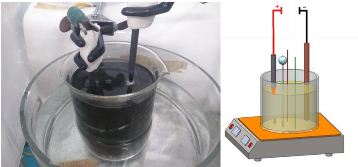
Hình 2.2 Sơ đồ hệ điện hóa anodic và hình ảnh sơ đồ bố trí thí nghiệm.
